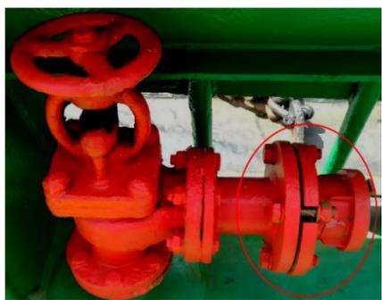
船上有三种国际通岸接头，是指消防水国际通岸接头、生活污水标准排放接头、污水水标准排放接头。缺陷案例一：PSCO检查消防管系时，发现该轮三副将消防水国际通岸接头直接连在左舷边国际通岸接头的法兰上，未存放在《船舶防火控制图》标识的位置。
