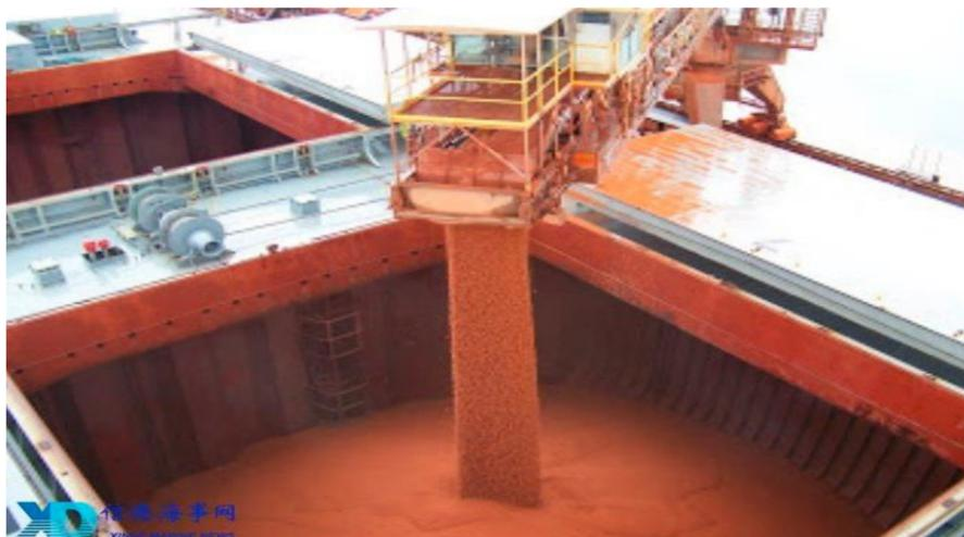
1. 2015年1月，一艘散货船（当时10年船龄，巴哈马旗）运送46,400吨铝矾土前往中国的过程中发生事故，迅速沉没，最终导致18人遇难。IMO遂发出警告（warning）提醒船东、船舶经营人、以及船长，使用散货船运输铝矾土时可能会出现货物“液化”的现象而进一步导致致命危险情况的发生。
